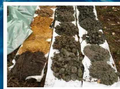
Mit Hilfe der Aufschlussbohrung ist erkennbar, wie der Boden geschichtet ist und wo die wasserführenden Schichten lagern.
